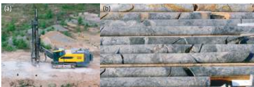
Figura 2.17. Sondagem geológica (a); testemunhos da sondagem (b).
